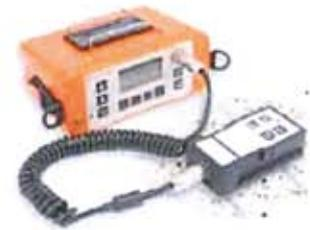
La posizione dei ferri è stata determinata muovendo il dispositivo sulla superficie in esame, fino ad individuare la direzione di massimo assorbimento elettromagnetico che corrisponde all'orditura dei ferri. In questo modo viene ricostruita la maglia di armatura delle strutture.
