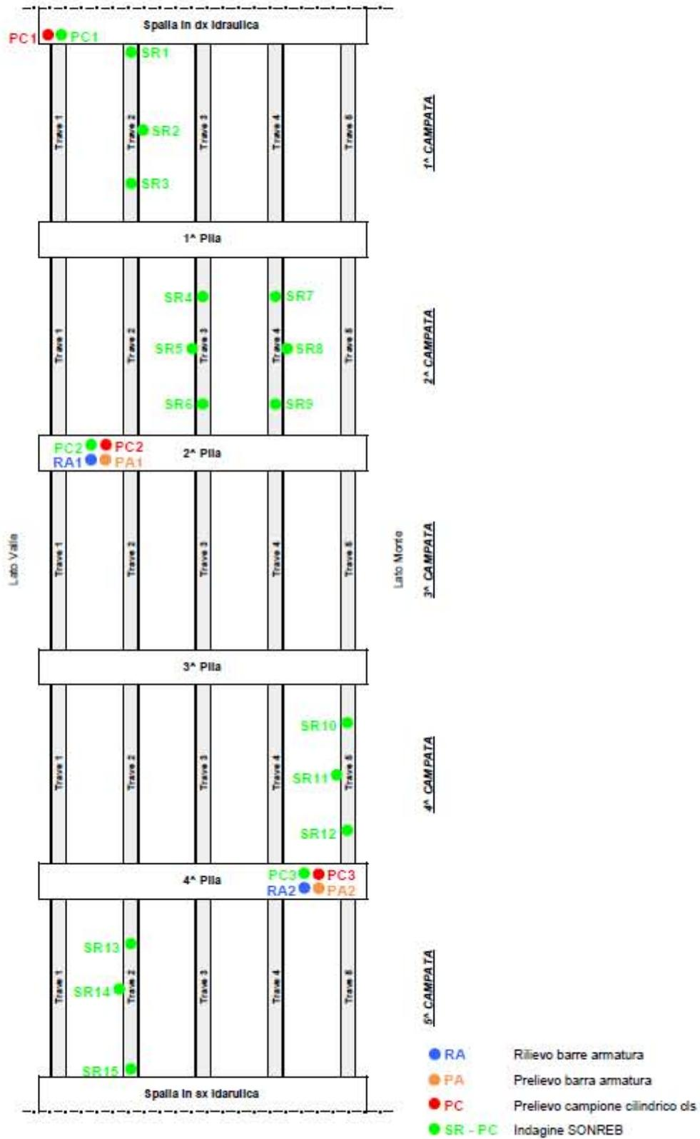
Dai rilevi delle barre di armatura effettuati nella 2° Pila in dx idraulica (RA1) e nella 4° Pila in sx idraulica (RA2) risulta che i ferri hanno diametri compresi tra  $\phi 12$  e  $\phi 14$  verticali,  $\phi 8$  e  $\phi 10$  orizzontali. Tali armature sono congruenti con quanto riportato negli elaborati grafici del progetto originario del ponte sul fiume Lamone, indicato dalla committenza come simile al ponte oggetto delle presenti verifiche.
